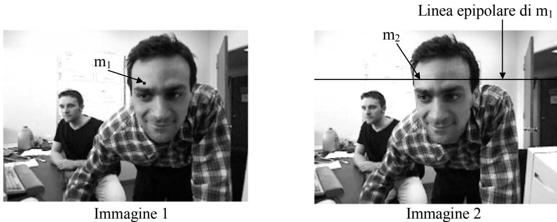
Figura A.5 – Geometria epipolare applicata ad immagini stereo
