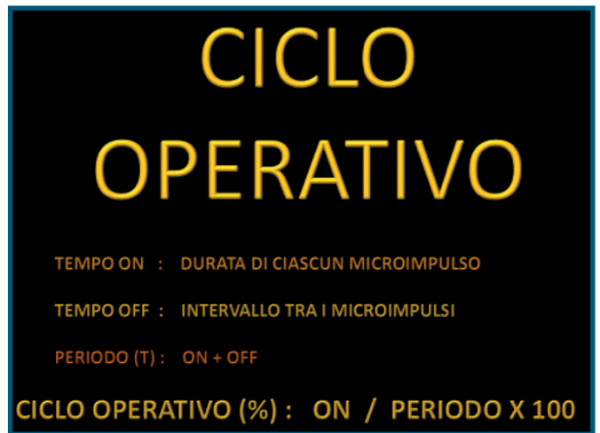
Fig. 6 - Il ciclo operativo è espresso, in percentuale (%), dalla durata di ciascun microimpulso (TEMPO ON) diviso il periodo (TEMPO ON + l'intervallo tra i microimpulsi TEMPO OFF) moltiplicato per 100
